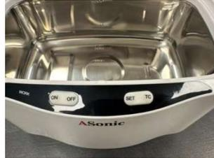
1. Vierta la solución de limpieza en el tanque de limpieza y coloque la canasta con los elementos a limpiar en el tanque. Conecte firmemente el enchufe de alimentación a una toma de corriente con conexión a tierra adecuada (220 V/50 Hz) después de llenar el tanque para garantizar la seguridad. La pantalla del limpiador ultrasónico mostrará la configuración del temporizador utilizada para el proceso de limpieza anterior.
