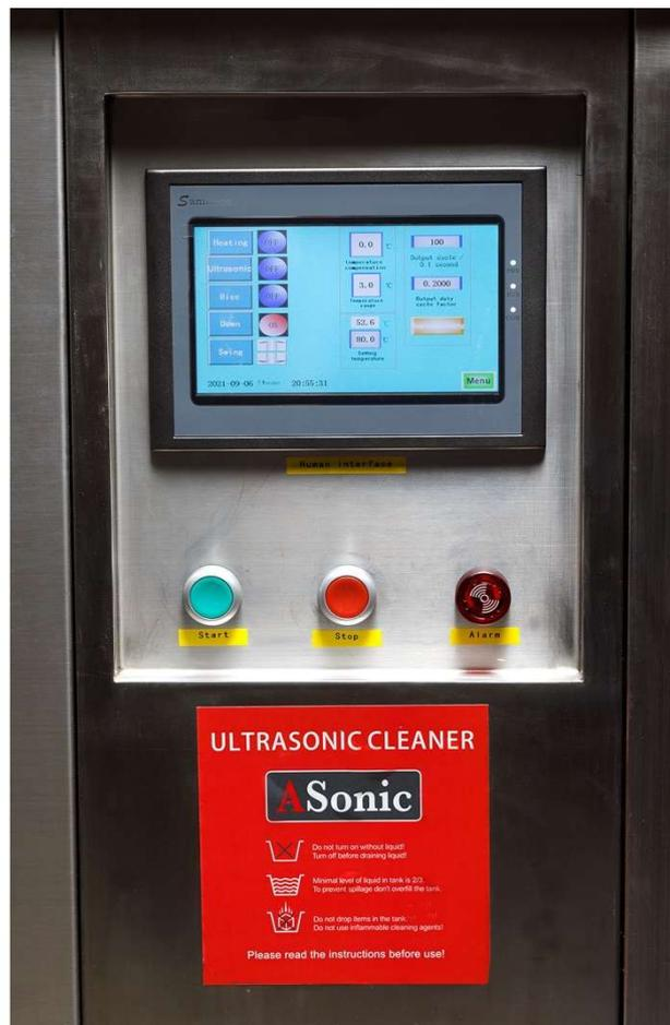
8. Cuando se alcanza la temperatura, la luz de funcionamiento del calentador se apagará y el calentador comenzará a funcionar nuevamente cuando la temperatura en el tanque baje 5 °C por debajo de la temperatura establecida. El panel LED muestra la temperatura actual cuando el ultrasonido está funcionando.
